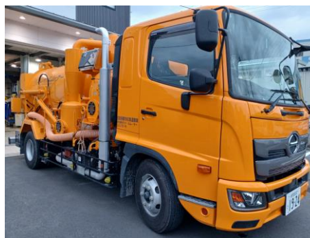
4m 3 の吸引車を導入しました。普段はWJの現場に常駐しています。
